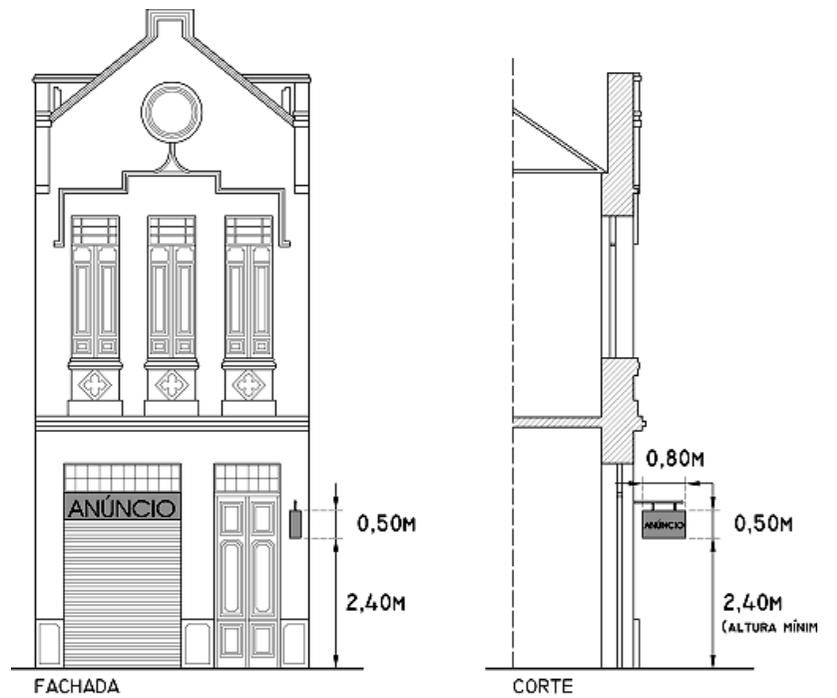
Figura 9 Dimensões máximas
