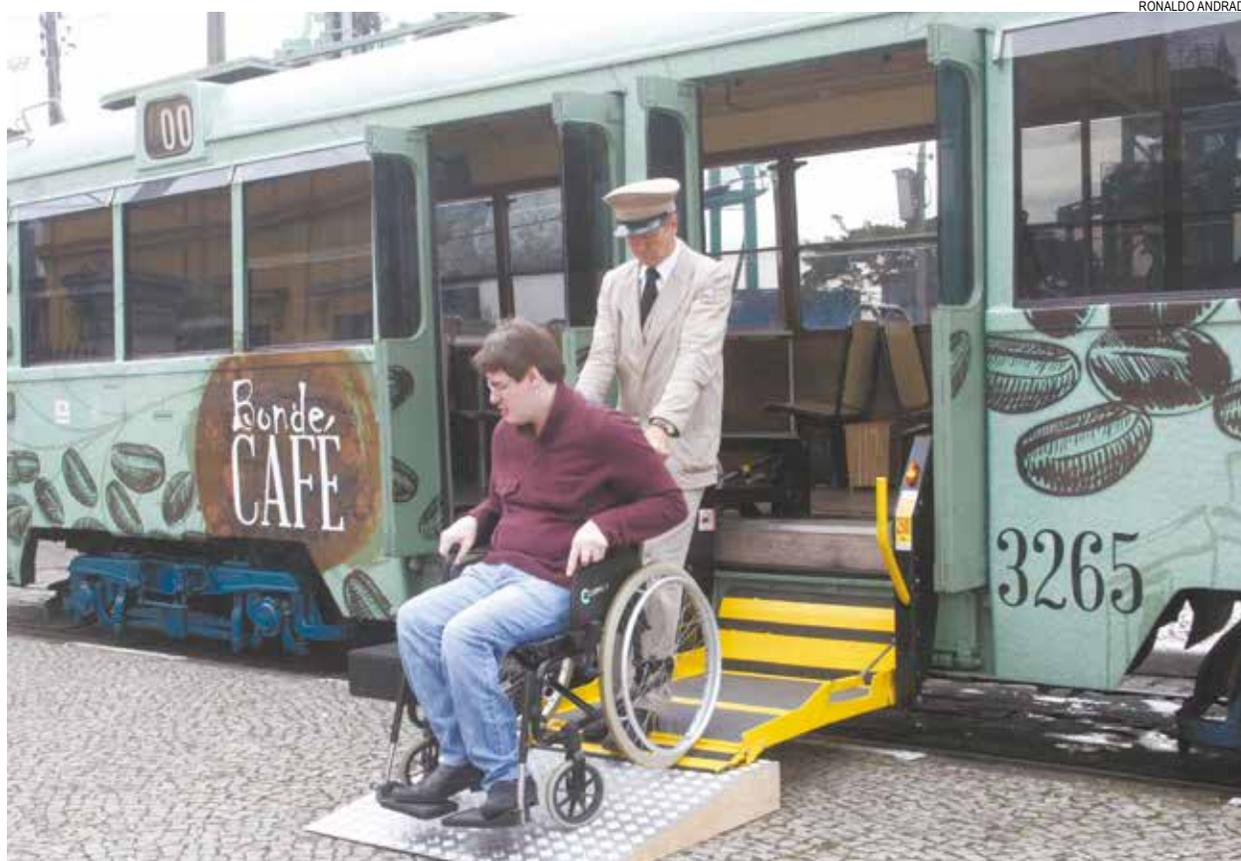
Plataforma elevatória de acesso ao veículo elétrico é similar à utilizada nos ônibus convencionais
