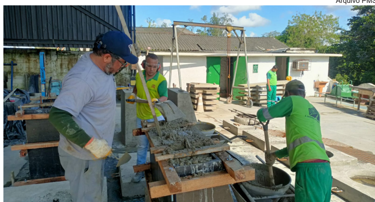
Concretagem de peças que serão utilizadas pela Prefeitura Regional da Zona Noroeste
