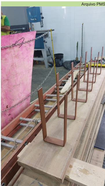
Produção de barra em formato de "U" para fixação em bicicletário
